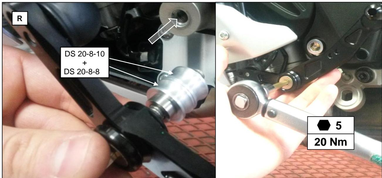
**R:** Installieren Sie den Schalthebel an die originale Montageposition (Pfeil). Verwendet werden die beiden Distanzscheiben **DS 20-8-10** und **DS 20-8-8**.
