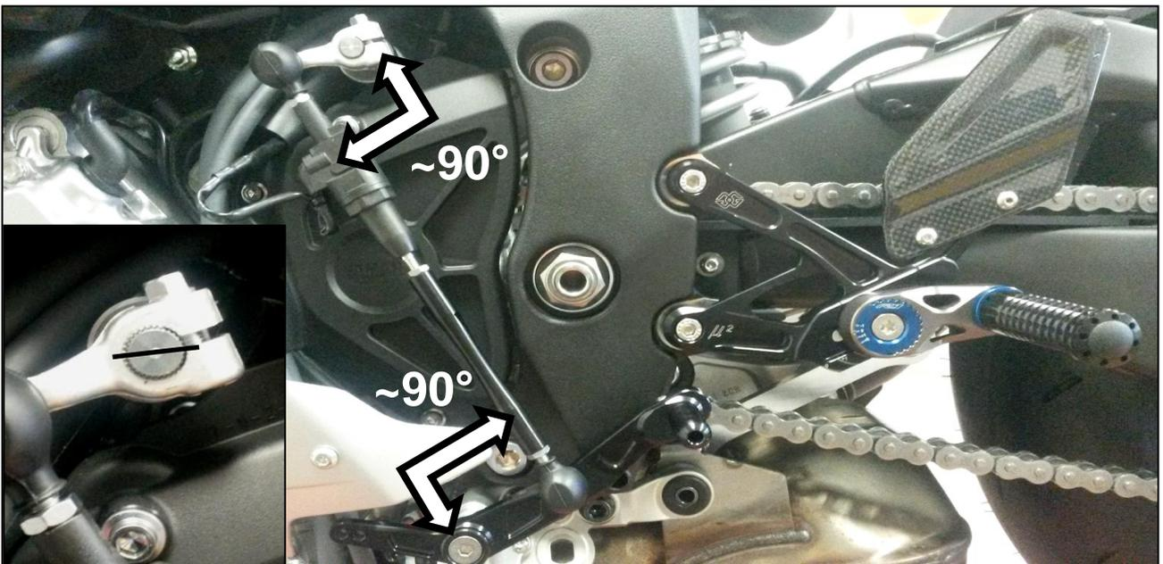
Der Schaltarm ist gemäß der Detaildarstellung zu montieren. Der Klemmspalt des Schaltarmes steht dabei über dem Anriss auf der Getriebeausgangswelle (und nicht wie vorher in der Verlängerung).
