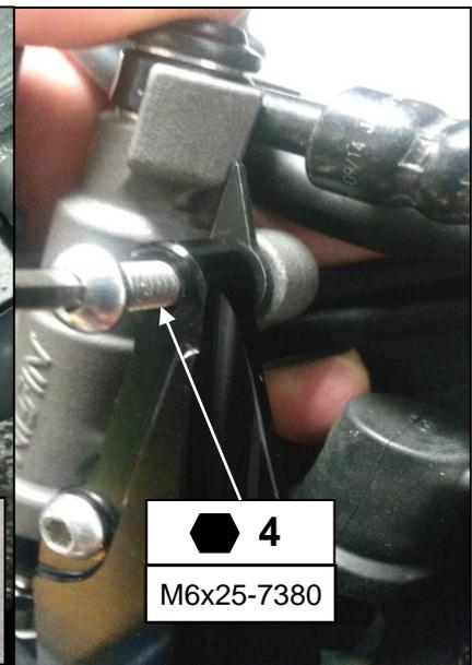
**I:** Mit Hilfe des Original-Halters werden die beiden Züge der Auspuff-Klappensteuerung angehoben und geführt. Der Halter wird zwischen Bremszylinder und Trägerplatte geschoben und anschließend mit der Schraube **M6x25-7380** fixiert.
