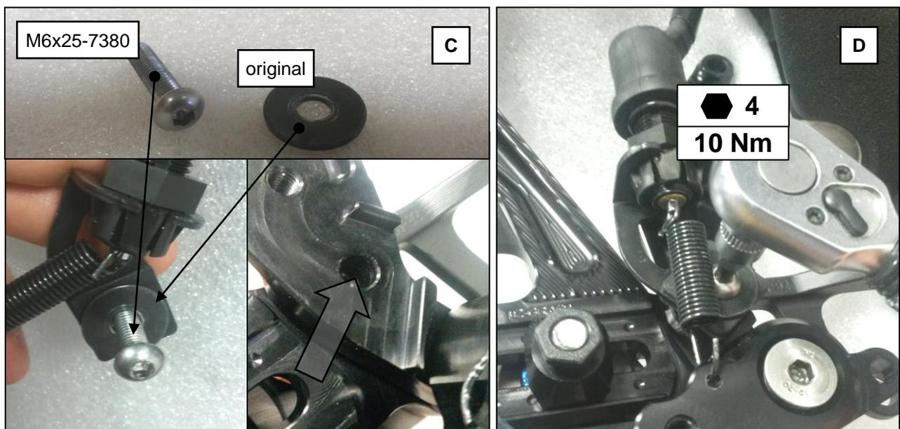
**C:** Einhängen der Feder (Einhängepunkt in Bild D). Montieren Sie den Bremslichtschalter.
