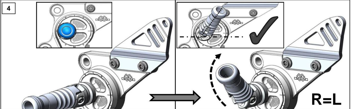
**5:** Montieren Sie die Fussraste in umgekehrter Reihenfolge zur Demontage (Schritte 1.1 bis 1.4).
