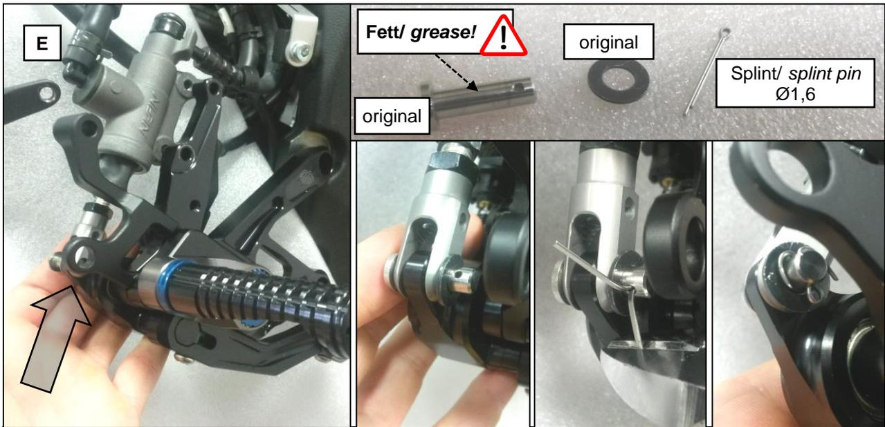
**E:** Verbinden Sie gemäß Darstellung E den Bremszylinder und dessen Gabeladapter mit dem Bremshebel der Rastenanlage.
