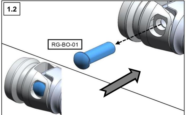
1.1 / 1.2: Entfernen Sie die Schraube (M4x8-14583) und den Bolzen (RG-BO-01) gemäß der Darstellungen.
