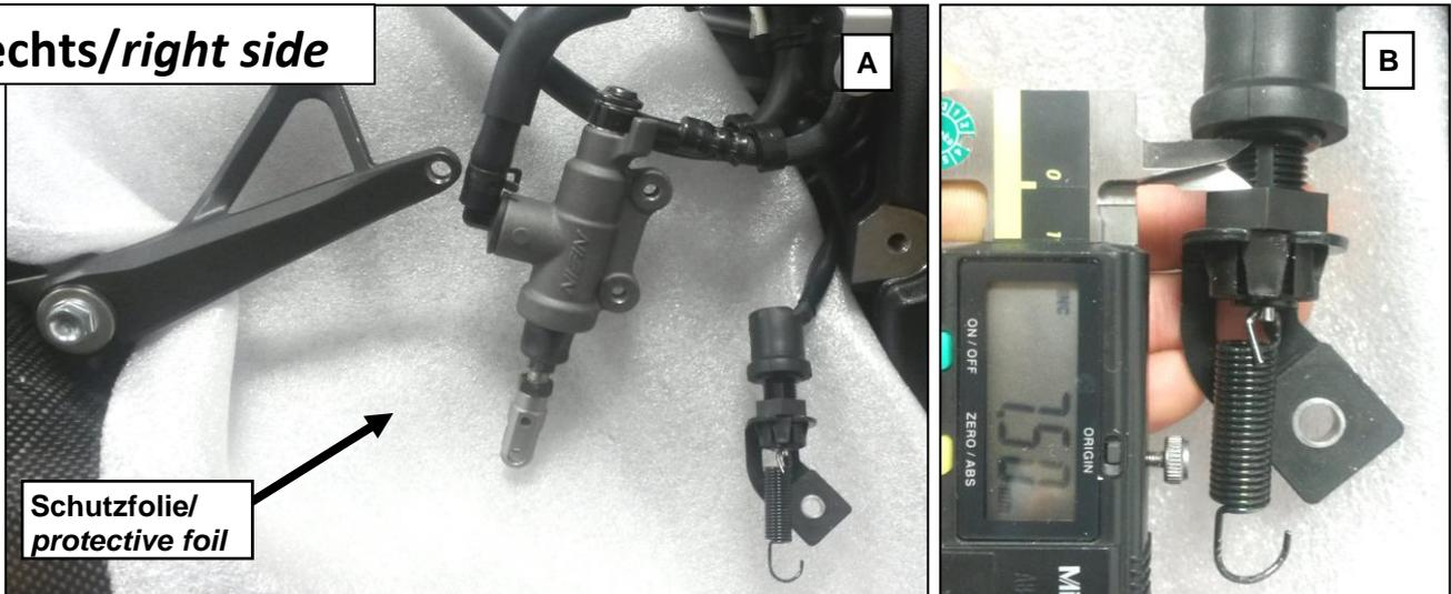
**A:** Original Rastenanlage demontieren und Auspuff, sowie Schwinge durch Abdecken gegen Beschädigungen schützen wie im Bild dargestellt.
