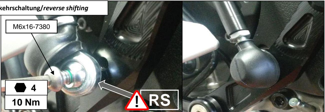
Montieren Sie den Kugelkopf mittels Schraube **M6x16-7380** auf die Vorderseite des Schalthebels! **Nutzen Sie die Serien- Umkehrposition,- gekennzeichnet durch Gravur RS!** (10 Nm)
