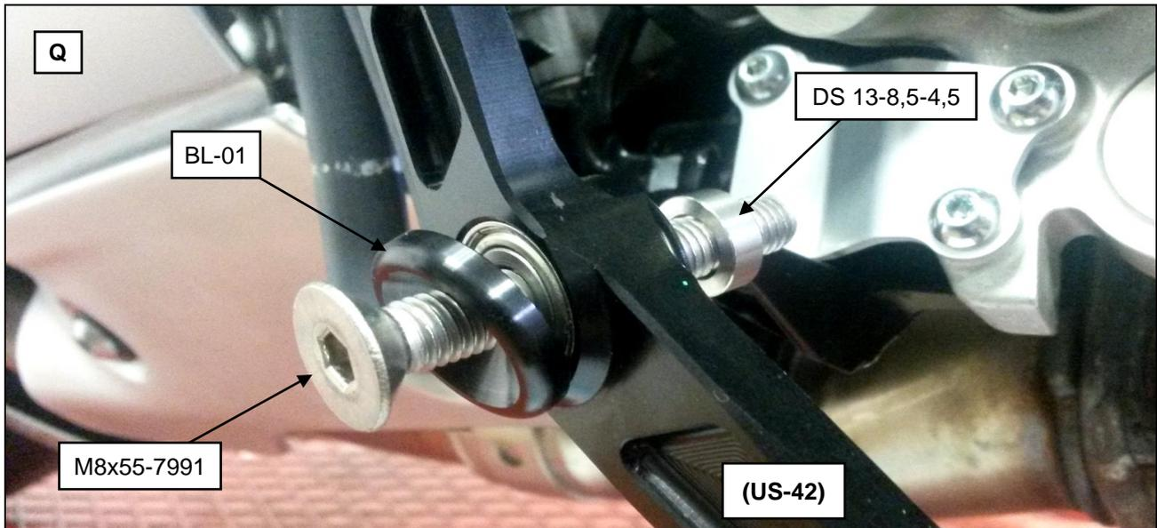
**Q:** Stecken Sie die Schraube **M8x55-7991** durch die spezielle Abdeckung **BL-01**. Fügen Sie diese anschließend durch die Lagerung des Schalthebels. Auf der Rückseite der Lagerung kommt die Buchse **DS 13-8,5-4,5** zum Einsatz.
