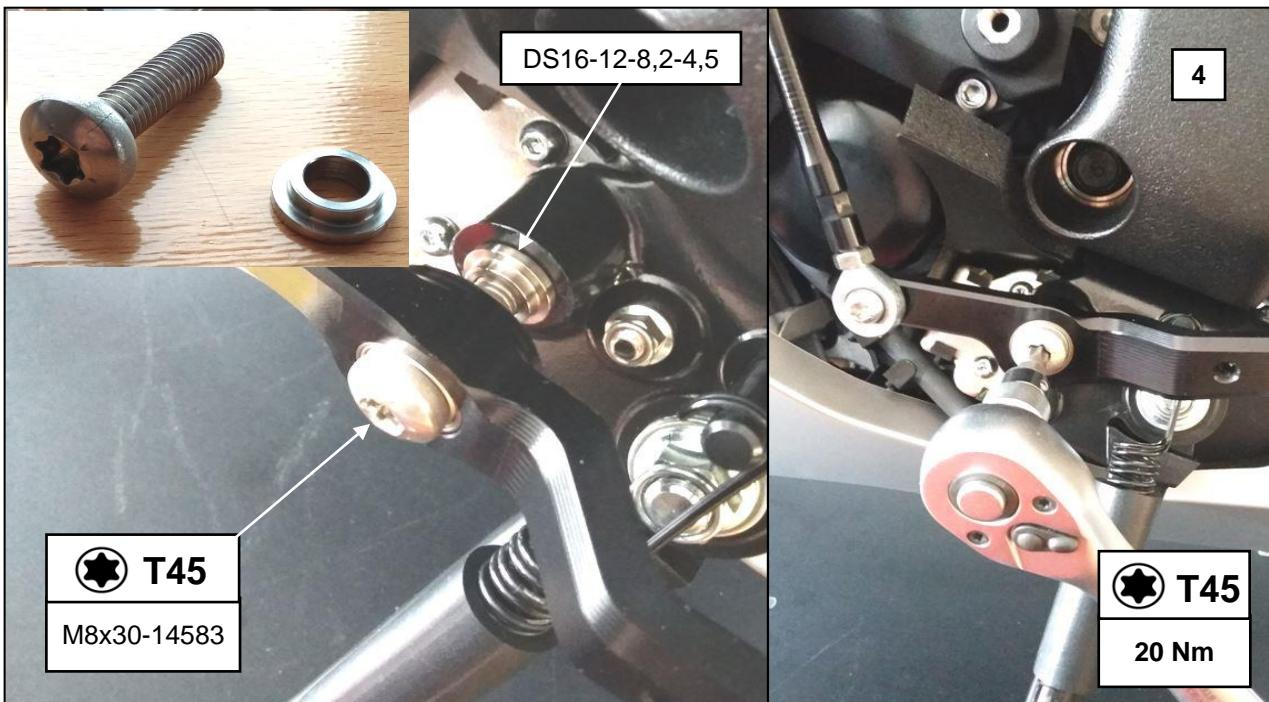
**4:** Montieren Sie den Schalthebel mit der angegebenen Auflagescheibe DS16-12-8,2-4,5 (kleiner Bunddurchmesser in Richtung Rillenkugellager des Hebel)s) und der Schraube M8x30-14583-VA-TX! Anzugsdrehmoment: 20 Nm
